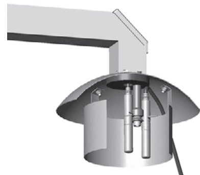
Zur Kalibrierung lässt sich die portable Referenzsonde HMP77 einfach neben der Sonde des HMT337 anbringen.
