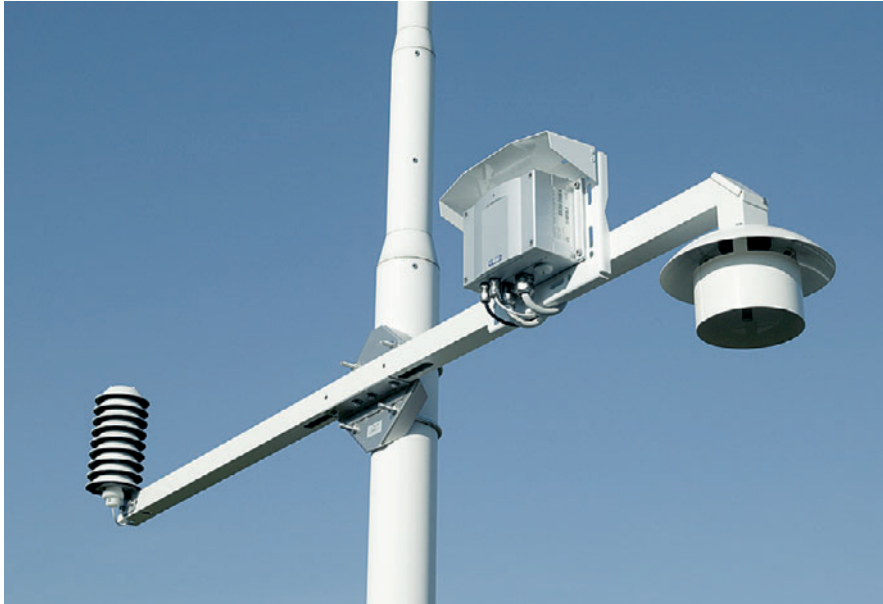
Der HMT337 mit beheizter Sonde ist unter Verwendung des Montagesatzes HMT330MIK die richtige Wahl für zuverlässige Feuchtemessungen im Freien.
