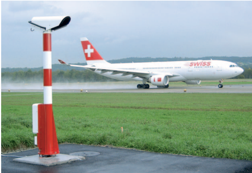
Der Vaisala Transmissometer LT31 ermöglicht genaue und zuverlässige Messungen mit nur einer Messbasis für Flughäfen der Kategorie CATIIIb
