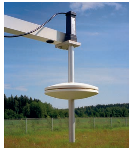
気圧取入れ口SPH10にPTB210を取付けた状態
